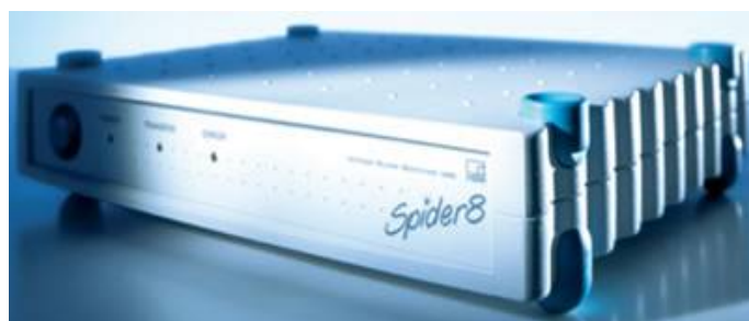
Fig.5. Sistem de achiziție a datelor SPIDER 8
