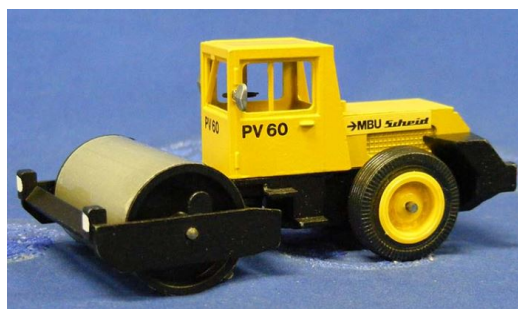
Fig.3 Compactor vibrator autopropulsat mixt de 130kN (tip PV60 firma MBU).
