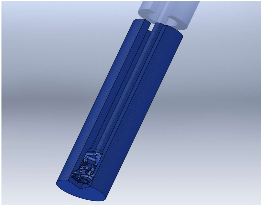
Fig. 10. SECȚIUNE PRIN VOLUMUL LICHIDULUI DE FORAJ
