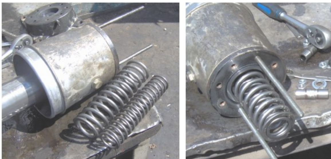
Fig.8. Ansamblu de arcuri din componența maiului compactor
