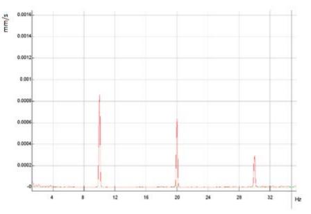
Fig. 5. Vibration FFT spectra on the fan
